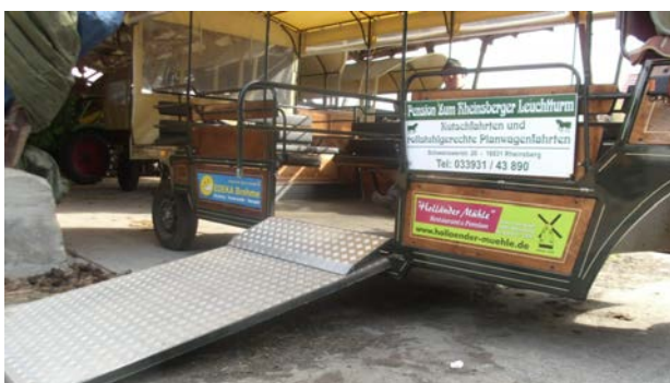
Tiefergelegter Kremser mit 6%iger Rampe für einen sicheren und selbstbestimmten Einstieg
